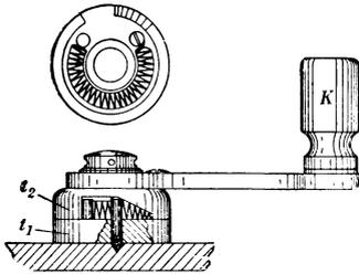
FIG. 52.—( $\frac{1}{3}$  actual size.) Construction of the crank.
