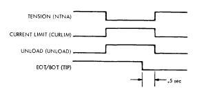
Figure 4-8. Unload Timing
